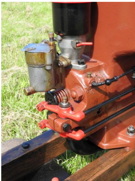
Dieser Deutz-Viertakt-Ottomotor vom Typ MA608 wurde von Peter Gosemann gezeigt. Er hat mit einer Bohrung von 70 mm und einem Hub von 80 mm einen Hubraum von 308 cm 3 und leistet 4 PS bei 2000 Umdrehungen. Die Kühlung erfolgt durch Verdampfung. Dieser Motor wurde in großen Stückzahlen gebaut: rund 55.00 Stück wurden von 1931 bis 1954 hergestellt. Das ausgestellte Exemplar trägt die Nr. 42705. 5
