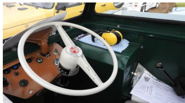
1964 erschien der erste Multicar, der M22 mit Einmannfahrerhaus. Der im Bild sichtbare Ohrschutzhörer weist auf ein Problem hin – der luftgekühlte 2-Zylinder-Dieselmotor mit 15 PS aus Cunewalde war in der kleinen Kabine doch sehr laut zu hören. Ansonsten aber waren die geschlossene Kabine, die nun mehr „richtige“ Lenkung und der stärkere Motor eine großer Fortschritt für die Nutzer dieses Kleinlastwagens. 3
