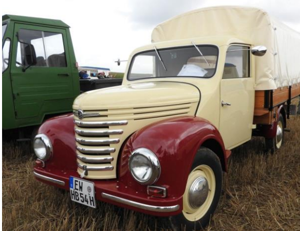
Ein Barkas V901/2 aus dem VEB Framo Werke Hainichen mit Pritsche und Plane. Er war werksmäßig mit einem 3-Zylinder-Wartburg-Motor ausgestattet, der mit 900\text{ cm}^3 28 PS leistete. Die Höchstgeschwindigkeit betrug 82\text{ km/h} . 1 Dieses schön restaurierte Exemplar, Baujahr 1961, wurde von Helmut Britzke aus Eberswalde gezeigt.
