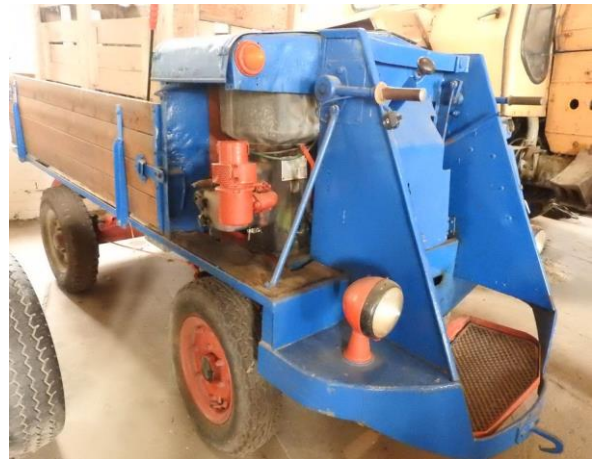
Die Multicar-Familie aus Walterdorf war gleich mehrfach vertreten. Hier ist das Vorläufermodell, die Dieselameise DK2003 von 1956/57 zu sehen, die noch mit einer Fußtritt-Steuerung durch Gewichtsverlagerung gelenkt wurde. Dieses Fahrzeug gehört zur Sammlung des Schönermarkter Vereins zur Förderung von Landwirtschaft, Handwerk und Kultur e.V.
