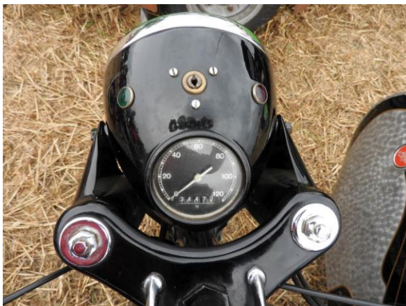
Laut Tachoanzeige hat diese BK350 34472 km auf dem Buckel. Dieses Motorrad wurde in Zschopau von 1952 bis 1959 gebaut. Sein Zweitakt-Boxermotor hatte einen Hubraum von 350 cm 3 , leistete je nach Variante 15 oder 17 PS und machte die Maschine 120 km/h schnell. 2 Die ausgestellte Maschine wurde 1954 gebaut und gehört Klaus Krüger aus Bad Freienwalde.
