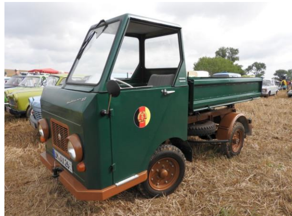
Die Multicar-Familie aus Walterdorf war gleich mehrfach vertreten. Hier ist das Vorläufermodell, die Dieselameise DK2003 von 1956/57 zu sehen, die noch mit einer Fußtritt-Steuerung durch Gewichtsverlagerung gelenkt wurde. Dieses Fahrzeug gehört zur Sammlung des Schönermarkter Vereins zur Förderung von Landwirtschaft, Handwerk und Kultur e.V.
