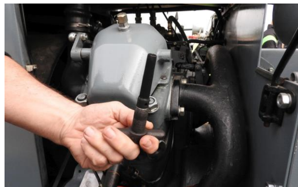
Der RS03/30 „Aktivist“ wurde von 1949-52 im Schlepperwerk Brandenburg hergestellt. Zum Starten des wurde eine Lunte in diese Halterung geklemmt, die danach wieder in den Zylinderkopf eingeschraubt wurde - und dann hieß es kräftig kurbeln!
