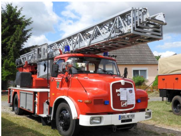
Dieser MAN DLK 23-12 gehört der Freiwilligen Feuerwehr der Stadt Liebenwalde. Das Fahrzeug wurde 1982 gebaut. Die Drehleiter kann bis auf eine Länge von 30 m ausgefahren werden. Die maximale Rettungshöhe beträgt 23 m bei 12 m Ausladung.
