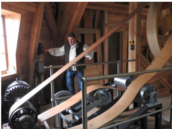
Bernd Strack kontrolliert den Lauf der Antriebs-riemen.
