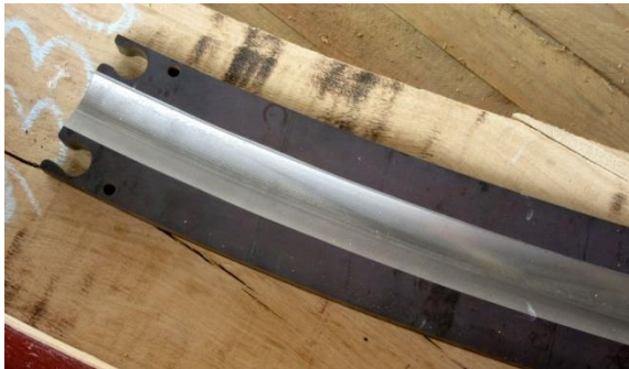
Aus solchen 20 mm starken Segmenten wird die untere Laufbahn zusammengesetzt. In der Kehle werden später die 30 Kugeln laufen, welche die Kappe tragen. (Foto: H. Hinze)
