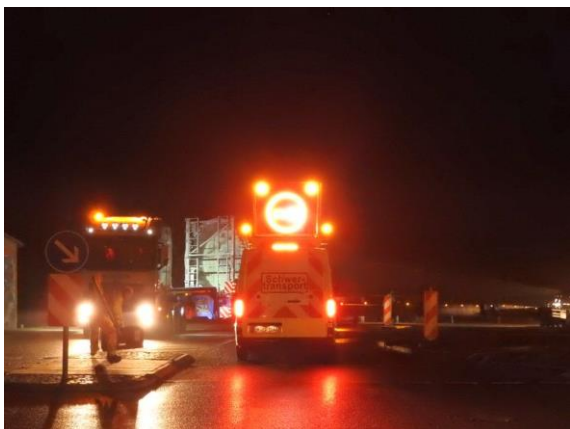
Nur mit Hilfe der gelenkten Achsen des Spezialaufliegers konnte diese Kurve befahren werden.
