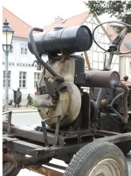
*Der Motor EL 308 leistete bescheidene 6 PS. Er musste von Hand gestartet werden. Auch vom Trabant fand ein Teil Verwendung - das Lenkrad.*
