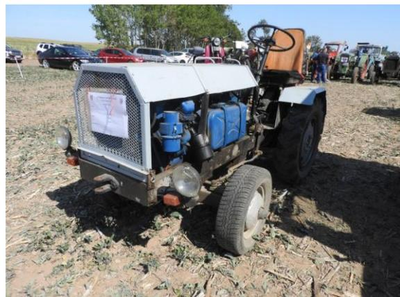
*Dieser Eigenbau-Traktor von Thomas Grieser wurde 2019 auf dem Schönermarker Traktorentreffen gezeigt. Er wird von einem Multicar-Motor angetrieben.*
