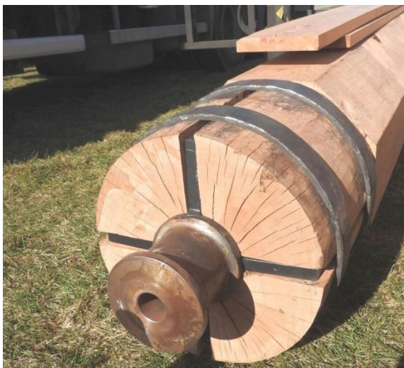
Die aus Eichenholz gefertigte Flügelwelle ist gut 7 m lang. Hier sieht man den hinteren Lagerzapfen.
